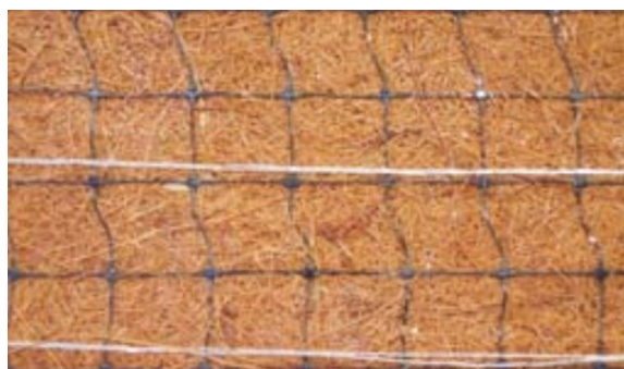
Figura 1.– Composición de la Manta de Control de Erosión AEC Premier Coconut™
